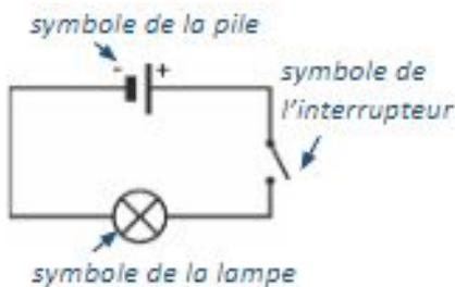
Schéma électrique d'une lampe
